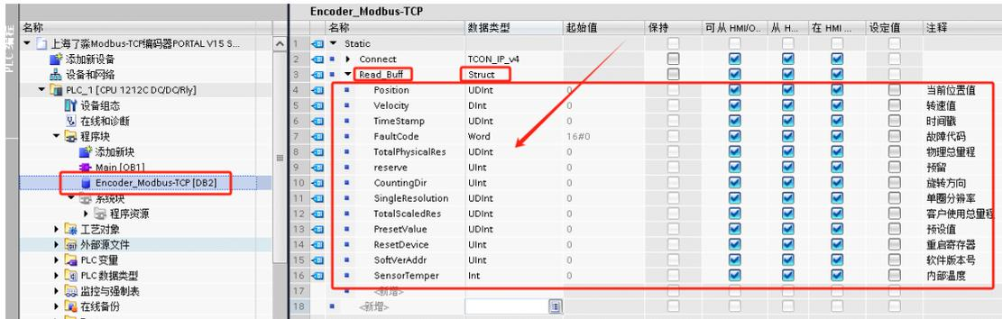
(7) 在 Encoder\_Modbus-TCP 数据块中创建 Struct 类型的写入编码器数据变量组 Write\_Buff, 并新建可以写入的编码器 Modbus-TCP 寄存器。
